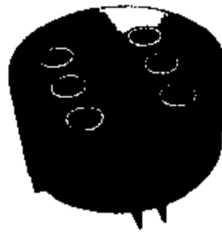
图 2.02.1-3a 滴流盘式分布器(用于小塔)
