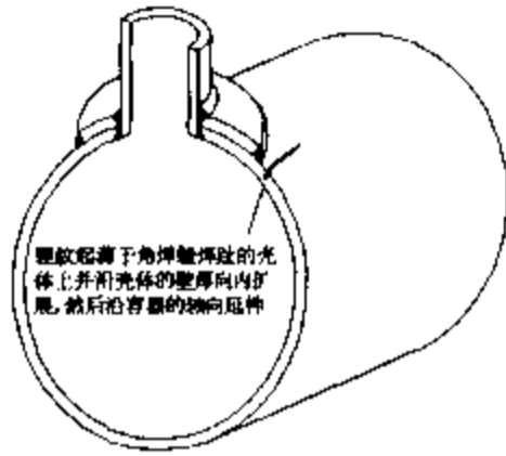
图 5.01.03-4 开口接管与壳体连接焊缝的焊趾示意图
